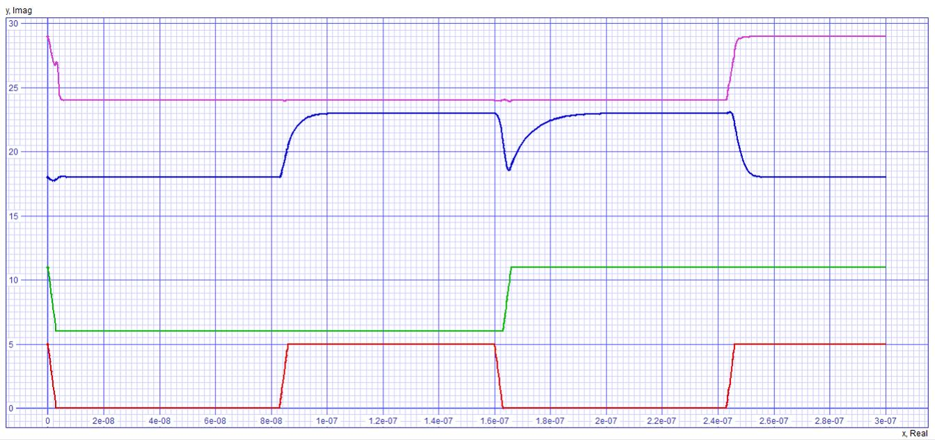
Figura 14: Meio-somador com carga capacitiva de 800fF
