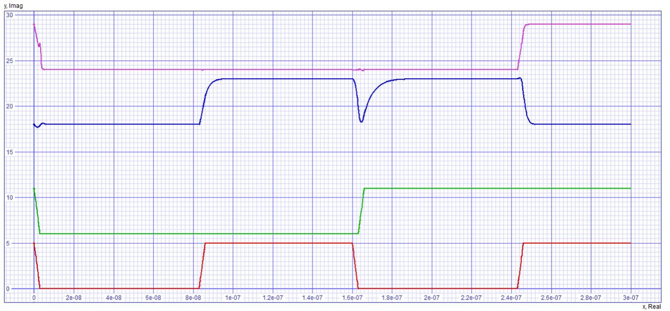
Figura 15: Meio-somador com carga capacitiva de 800fF e  $W=18 \lambda$
